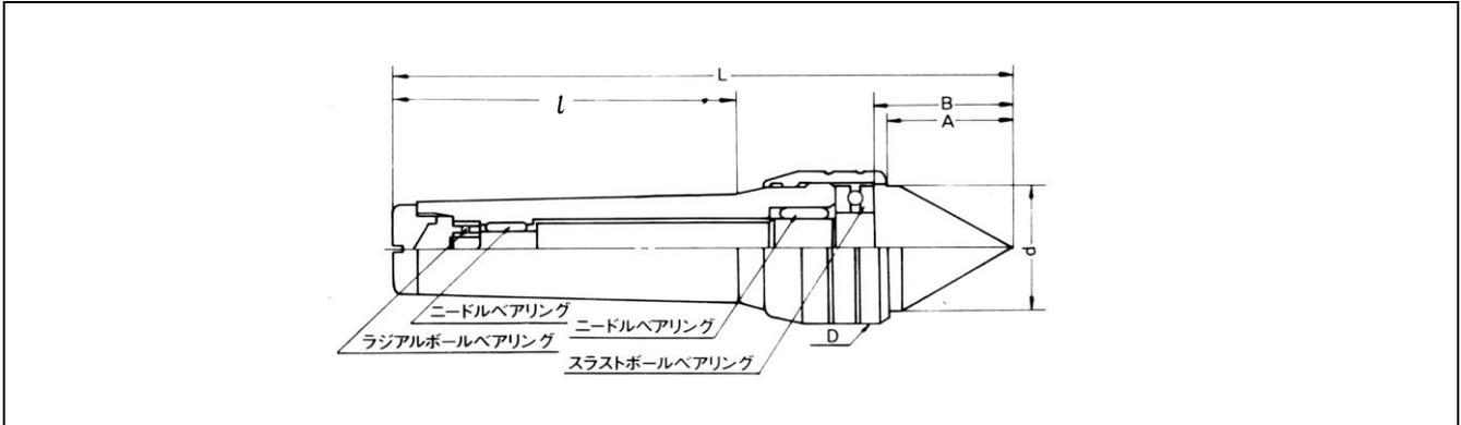
本ローリングセンターは、ニードルベアリングを主体に、ボールベアリングを適切に配することにより、外部形状をコンパクトに、然も負荷容量の大きい、高い剛性と作業範囲の広い、ライブセンターであります。低速から高速まであらゆる酷使に耐えるべく設計され、永年のツーリング製作の技術を傾注して加工された構成部品は、高い互換性と耐摩耗性を備えて居ります。
