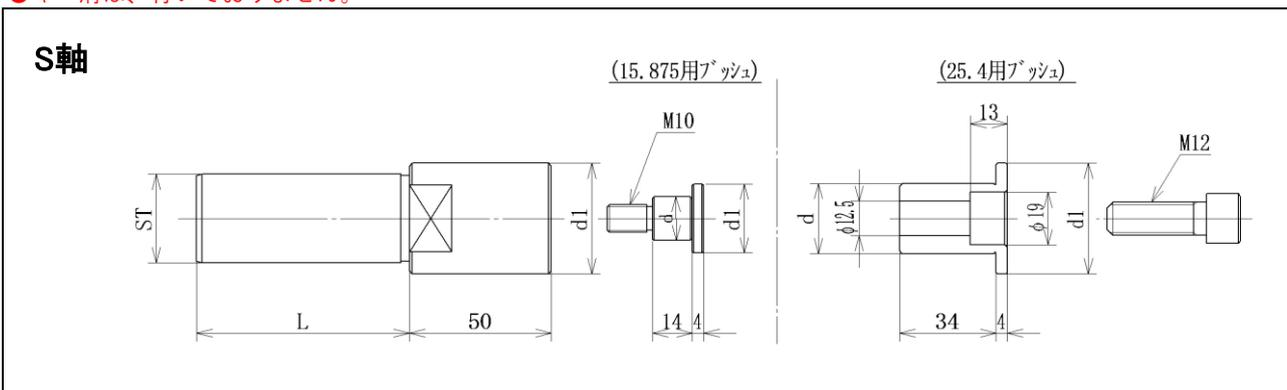
φ25.4用は、上記のボッシュをキャップボルトにて締め付けます。
