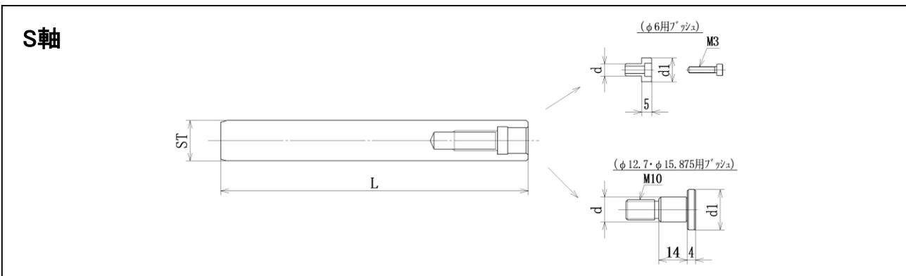
φ6用は、上記のボッシュをキャップボルトにて締め付けます。
